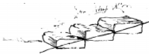
Figura A. Escalerines de piedra para pendientes pronunciadas.
